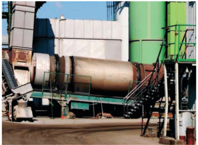
Anwendungsbeispiel: Drehrohr in der Chemieindustrie
