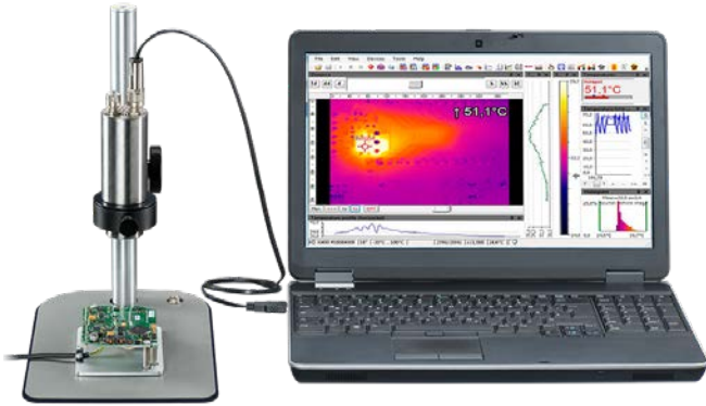
Mikroskopoptik Xi 400 für die Analyse kleinster Komponenten
